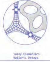
İkizler arası geliştirilen bağlantı Detayı (Moment aktaran bağlantı)
