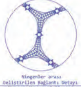
İkizler arası geliştirilen bağlantı Detayı (Moment aktaran bağlantı)
